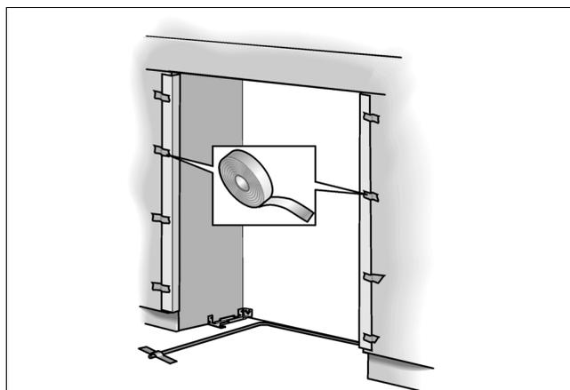
Pour protéger les bords de la cavité d'installation, utilisez les cornières de protection livrées d'origine et fixez-les avec du ruban adhésif.
