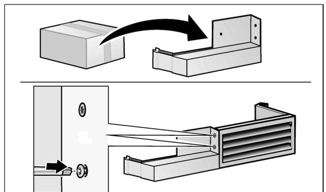
Pour adapter l'appareil au nouveau sens d'ouverture de porte, une pièce de rechange pour la grille d'aération a été livrée d'origine avec l'appareil.
