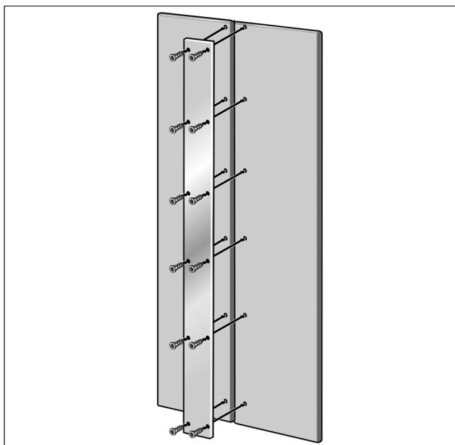
Ce bandeau métallique est disponible chez votre revendeur et constitue un accessoire d'installation (accessoire de jonction entre portes de meuble). Détails à ce sujet : voir la section « Accessoires et outillage nécessaires ».
