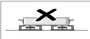
Ne faites jamais chauffer un récipient de cuisson (cocotte, poêle, pierre à griller) avec plusieurs brûleurs, car il en résulterait une accumulation de chaleur qui endommagerait l'appareil.
