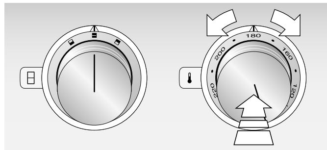
Nechcete-li potraviny připravovat na celé vyhřívané zóně, můžete levým ovládacím knoflíkem zvolit pouze přední nebo zadní část. Stlačte levý ovládací knoflík a zvolte požadovanou vyhřívanou zónu □ nebo □.
