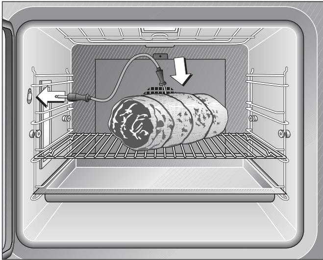
Der Kerntemperaturfühler ermöglicht exaktes, punktgenaues Garen.
