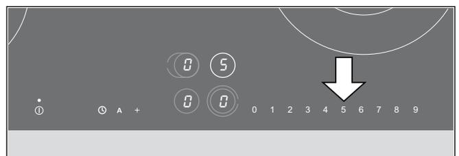
In der Kochstufen-Anzeige leuchtet die eingestellte Kochstufe. Nach wenigen Sekunden wird die Eingabe mit einem Signalton bestätigt.
