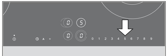
La position de chauffe réglée s'allume dans l'affichage des positions de chauffe. L'entrée est confirmée au bout de quelques secondes par un signal sonore.
