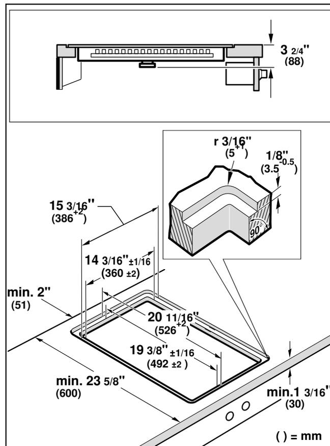
**Pose en affleurement:** L'appareil peut être encastré dans des plans de travail résistant à la chaleur et à l'eau, fabriqués dans les matériaux suivants :
