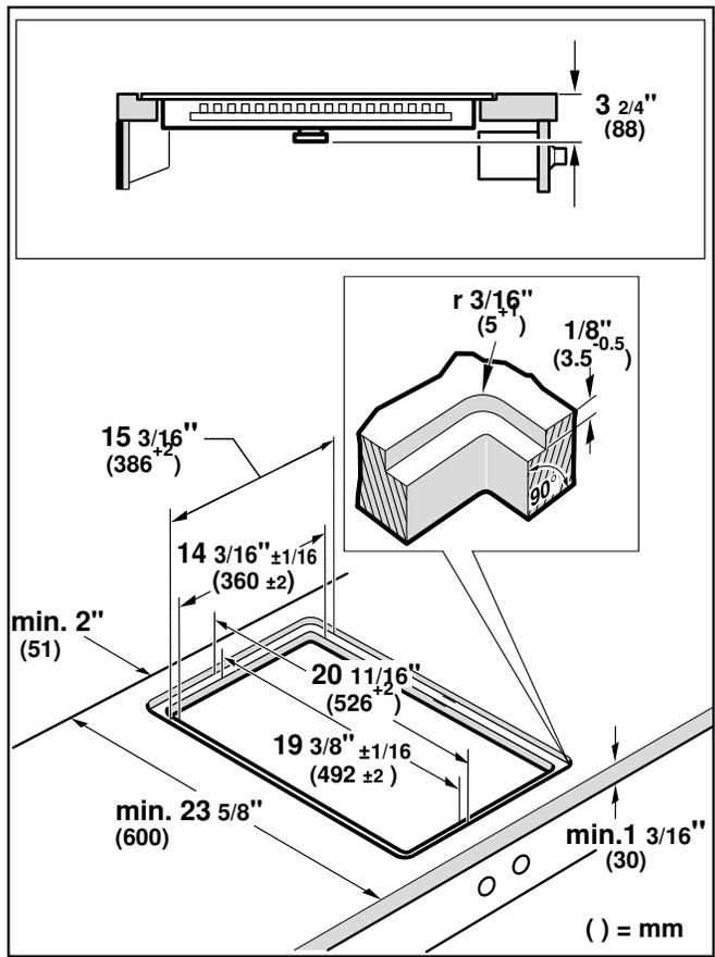
**Montaje a ras de superficie:** El aparato se puede montar en las siguientes encimeras resistentes a la temperatura y al agua:
