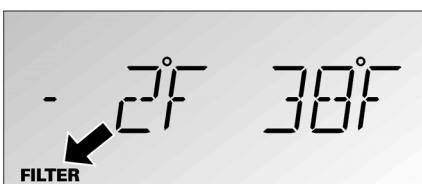
Cela signifie que la durée de vie maximale du filtre est sur le point d'expirer. Veuillez commander un nouveau filtre.
