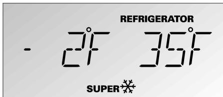
Se visualiza el símbolo **SUPER** y la temperatura para el enfriamiento rápido en el display.
