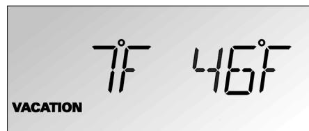
En vez de la temperatura requerida, se visualiza la temperatura preajustada para este modo.
