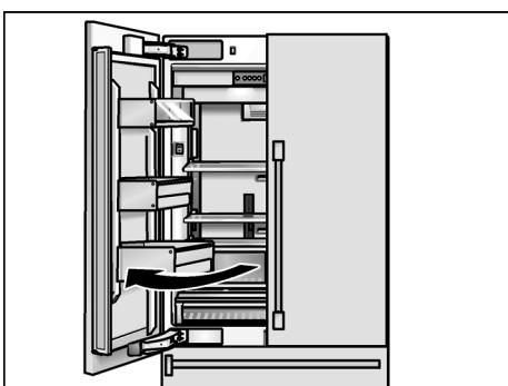
La variante 3 portes permet d'ouvrir la porte gauche du compartiment réfrigérateur sans ouvrir précédemment la porte droite.
