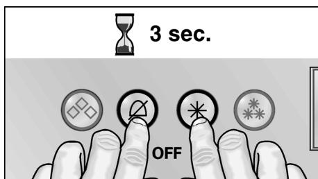
Accionar y mantener accionados simultáneamente por 3 segundos, los pulsadores Enfriamiento rápido  y Alarma .
