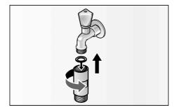
3. A l'aide d'une clé à fourche, raccordez le flexible d'arrivée d'eau et le joint au carter de filtre (si le montage n'a pas déjà été effectué en usine).
