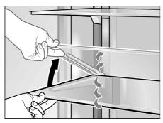
Abaissez l'avant de la clayette pour l'amener sur la hauteur désirée. Les supports encrantent dans le guide.
