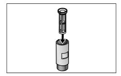
2. Posez le joint dans le carter de filtre et raccordezle au robinet d'eau (raccord fileté ¾'').
