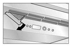
2. Extrayez le filtre à odeurs épuisé et mettez un filtre à odeurs neuf en place.
