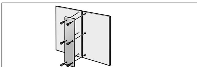
Ce bandeau métallique est disponible chez votre revendeur et constitue un accessoire d'installation (accessoire de jonction entre portes de meuble). Détails à ce sujet : voir la section « Accessoires et outillage nécessaires ».
