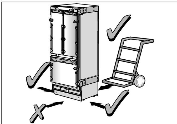
1. Transportez l'appareil avec un moyen adapté au site et à l'appareil lui-même (diable, chariot élévateur / transpalette, chariot).
