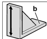
Pour régler correctement cette hauteur, il faut utiliser le gabarit de montage (b). L'arête supérieure du gabarit doit coïncider avec le repère sur l'appareil.
