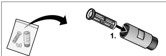
2. Posez le joint dans le carter de filtre et raccordez-le au robinet d'eau (raccord fileté 3/4").
