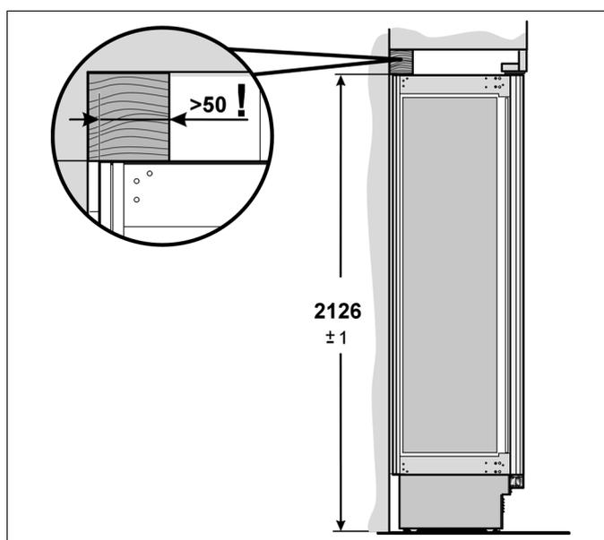
2. Sur la paroi arrière de la cavité, marquez la hauteur d'installation (bord inférieur de la poutre).
