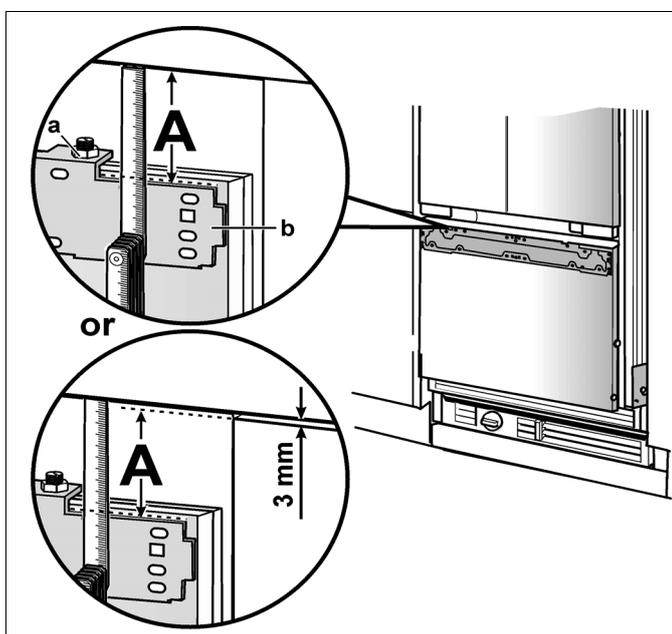
2. Desserrez les 2 écrous (a) et retirez le profilé d'ajustage (b).
