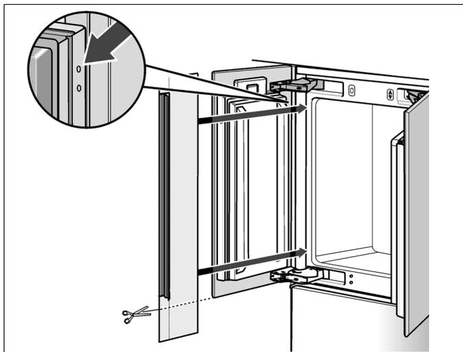
2. Insérez le bandeau protège-doigts dans l'interstice entre l'appareil et la paroi de la cavité (1.).
