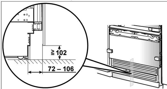
1. Le cas échéant, il sera nécessaire de découper le bandeau de socle à la longueur nécessaire.
