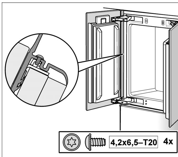
5. Ouvrez et fermez plusieurs fois la porte pour vérifier le fonctionnement du bandeau protège-doigts et qu'il n'oppose pas de résistance mécanique.
