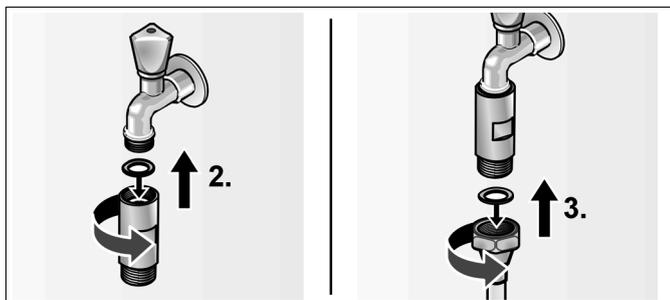
4. Posez le tuyau de raccordement. Posez toujours dans les zones indiquées pour éviter tout endommagement du tuyau ultérieurement lors de l'encastrement de l'appareil.
