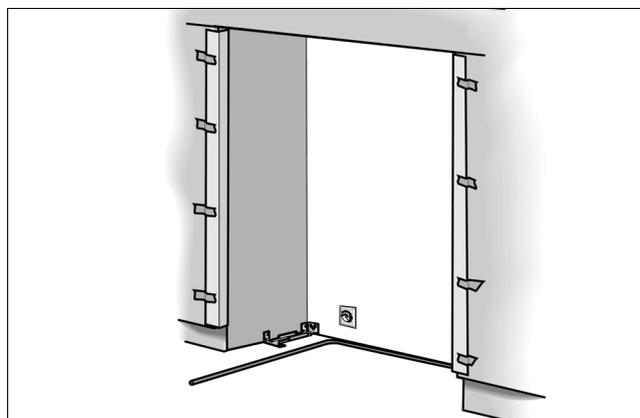
Um die Kanten der Einbaunische zu schützen, die mitgelieferten Schutzschienen mit dem Klebeband anbringen.
