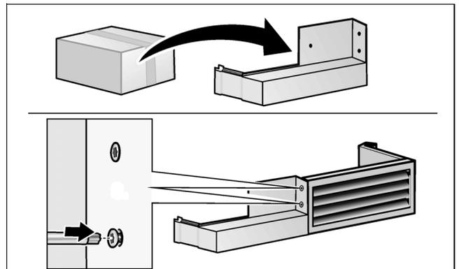
Zur Anpassung an den geänderten Türanschlag liegt dem Gerät ein Austauschteil für das Lüftungsgitter bei.
