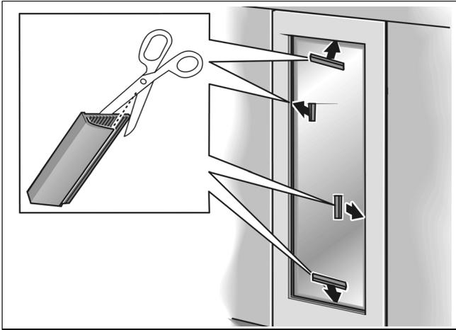
Bei geringer Rahmenbreite muss unter Umständen der Schenkel der Abdeckleiste gekürzt werden. Um die benötigte Länge des Schenkels zu ermitteln, liegen Probestücke der Abdeckleiste bei.
