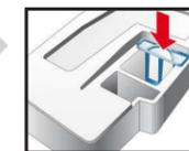
5. Réintroduisez le réservoir d'eau de condensation et poussez-le jusqu'à ce qu'il s'enclenche.
