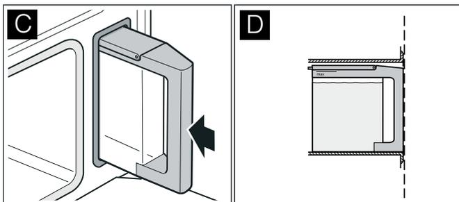
Der Tank muss bündig mit dem Tankschacht sein (Bild D).
