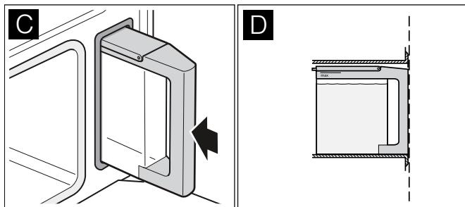
水箱必须与水箱安装槽齐平（图 D）。
