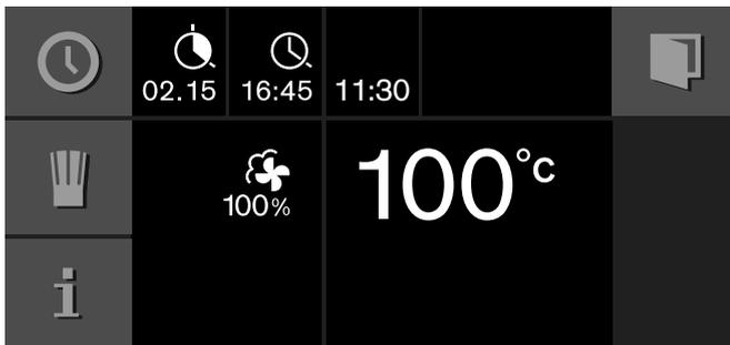
Das Gerät geht in Warteposition. In der Anzeige erscheinen die Betriebsart, die Temperatur, die Garzeit und das Garzeit-Ende. Das Gerät startet zum errechneten Zeitpunkt und schaltet automatisch aus, wenn die Garzeit abgelaufen ist.
