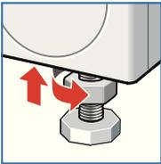
3. Serrez le contre-écrou contre le capot de l'appareil.
