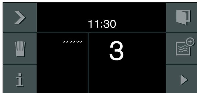
Selon le mode de fonctionnement sélectionné, le symbole ☞ pour micro-ondes ou le symbole ☞ pour gril grande surface apparaît dans le bandeau de commande de droite. Il permet d'ajouter respectivement un autre mode de fonctionnement.
