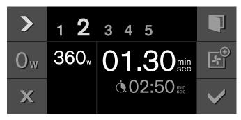
**说明:**您可在两种微波功率之间设置一个稳定时间,以确保食物内部的温度均匀分布。为此,触摸  $\mathbf{O}_{\mathbf{W}}$  符号,使用旋转选择钮设置一个时间。
