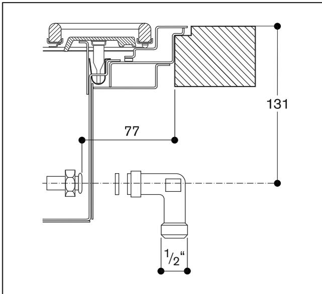
De gasaansluiting dient zodanig te zijn uitgevoerd dat de gaskraan toegankelijk is en zo nodig na opening van een meubeldeur zichtbaar is.
