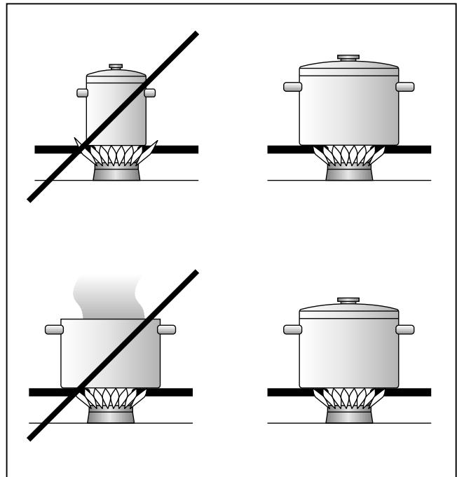
Évitez d'utiliser des casseroles d'un diamètre inférieur à **90 mm** ou supérieur à **280 mm** (**320 mm pour le wok à feu fort**). Si vous utilisez des ustensiles de plus grande taille, veillez à respecter une distance minimale de **50 mm** entre le récipient et les éléments environnants inflammables.
