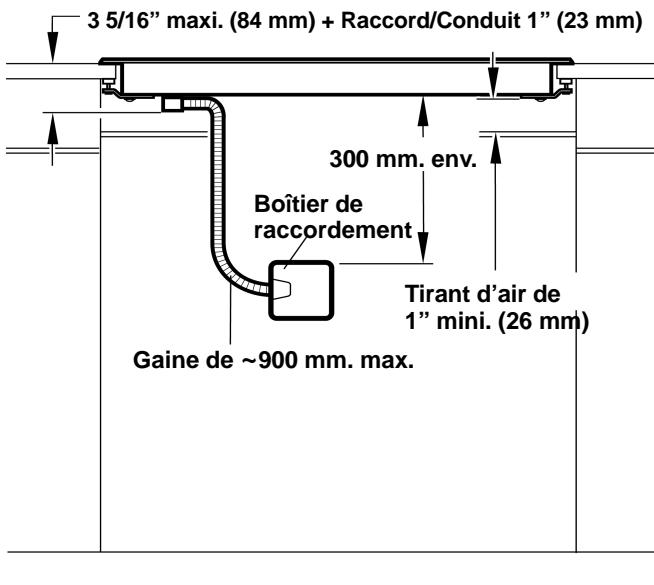
Ces caractéristiques techniques figurent sur la plaque d'identification au bas de l'appareil ménager. Le boîtier de dérivation doit être placé à ~900 mm. max. du branchement de la plaque. On doit pouvoir y accéder facilement pour effectuer les réparations.
