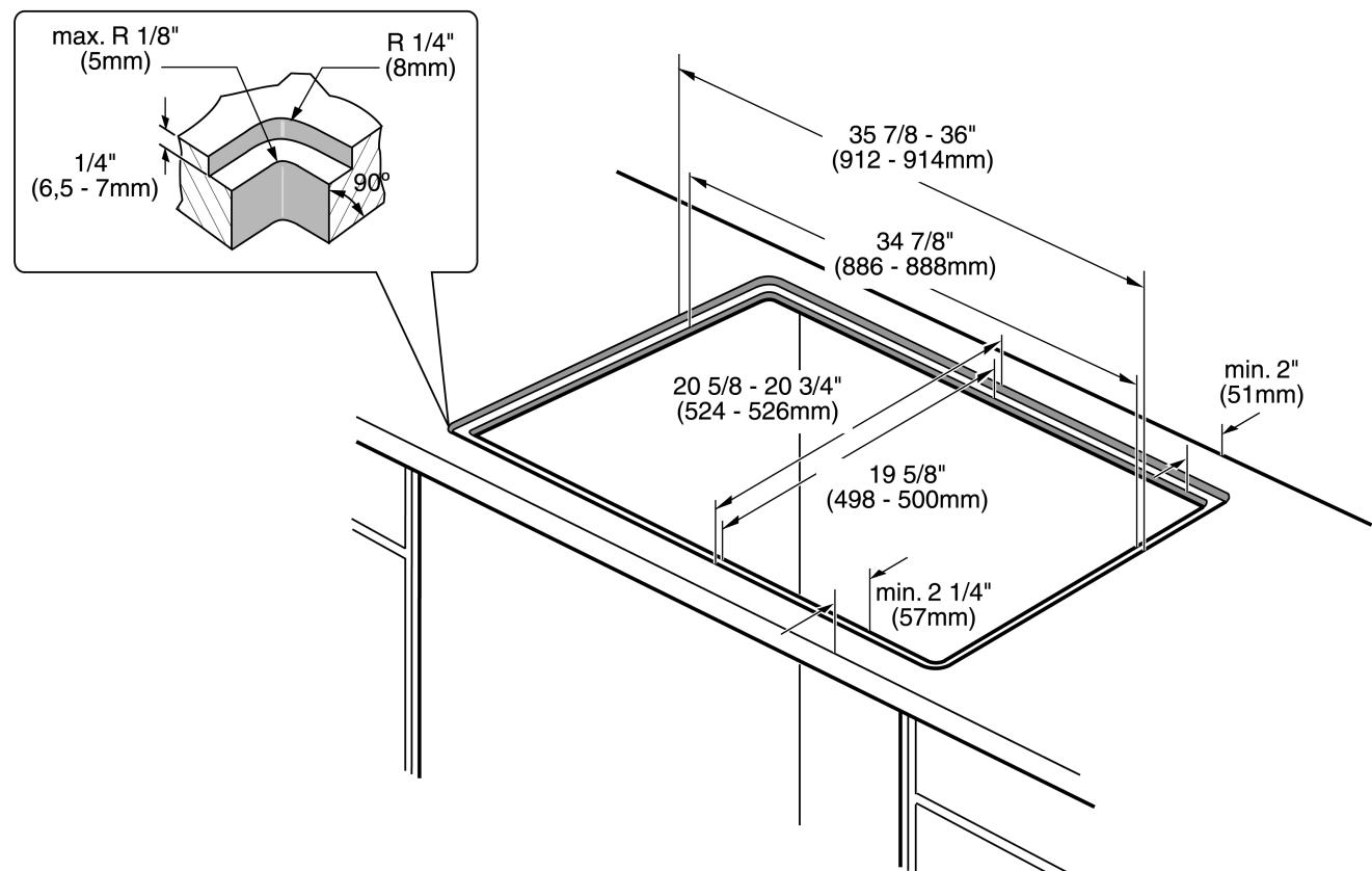
Las superficies de trabajo sólidas con frecuencia requieren instalaciones especiales. Por ejemplo, es posible que se necesiten cinta termorreflectante y esquineros redondeados. Para obtener las instrucciones específicas de su superficie de trabajo, comuníquese con el fabricante de la superficie de trabajo.
