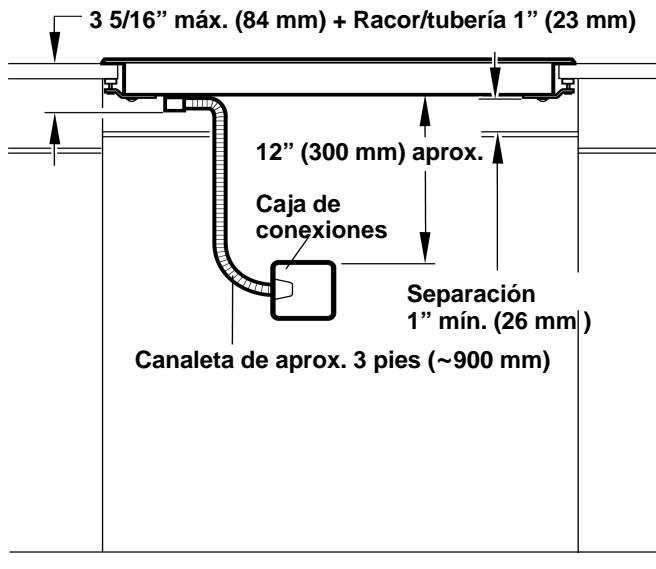
Puede encontrar la placa de identificación con las especificaciones eléctricas en la parte inferior del electrodoméstico. La caja de conexiones debe estar ubicada dentro de los 3 pies (~900 mm) de la conexión de la placa. Se debe poder obtener acceso a ella fácilmente para realizar las reparaciones.
