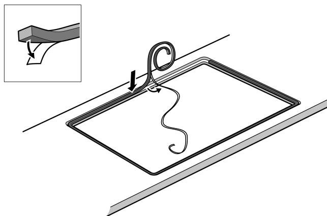
Pegar la junta adhesiva centrada sobre el escalón del mostrador (ver imagen).
