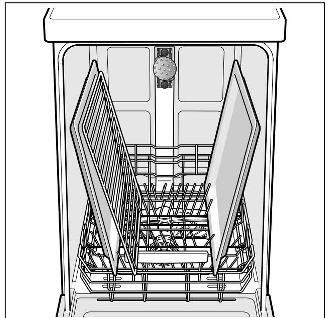
Große Bleche oder Gitter sowie Teller mit einem Durchmesser mehr als 30 cm (Gourmetteller, Pastateller, Platzteller) können Sie mit Hilfe dieses Sprühkopfes reinigen. Entnehmen Sie hierzu den Oberkorb und setzen Sie den Sprühkopf wie in der Zeichnung dargestellt ein.
