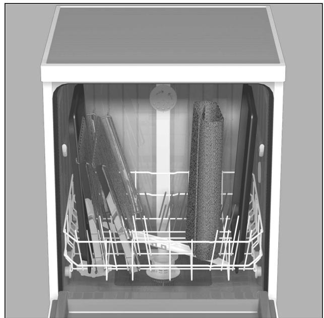
Con este cabezal pulverizador se pueden lavar bandejas pasteleras de gran tamaño, así como platos con un diámetro superior a 30 cm (por ejemplo platos para pasta, etc.). A tal efecto deberá retirarse el cesto superior del lavavajillas, montando el cabezal pulverizador en la máquina tal como se muestra en la ilustración.
