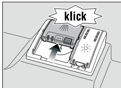
La cámara del detergente se abre automáticamente y en el instante adecuado, según el programa de lavado seleccionado. Los detergentes en polvo o líquido se reparten por todo el interior de la cuba del aparato, disolviéndose. Las pastillas de detergente, por su parte, son recogidas en la bandeja correspondiente, donde se disuelven de un modo dosificado.
