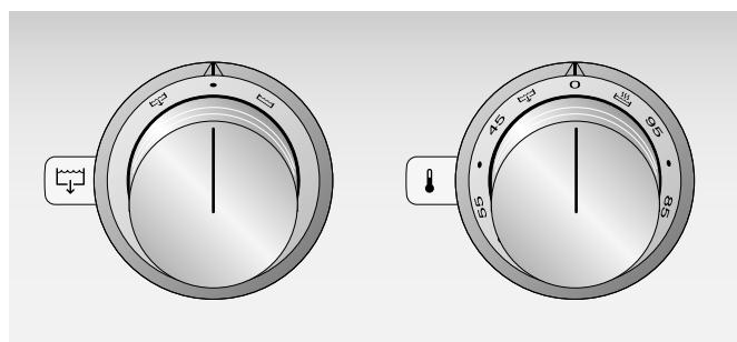
Sağ kumanda düğmesiyle 45 - 95 °C arası sıcaklık ya da sıcak tutma kademesini seçin.
