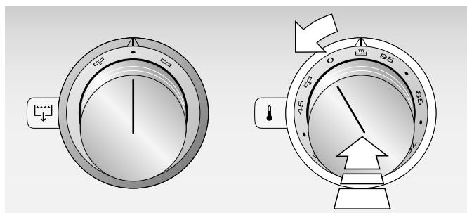
Cihaz ısındığı sürece sıcaklık kumanda düğmesinin arkasındaki ışıklı halka yanıp söner. Ayarlanan sıcaklığı ulaşıldığında ışıklı halka sürekli yanar.
