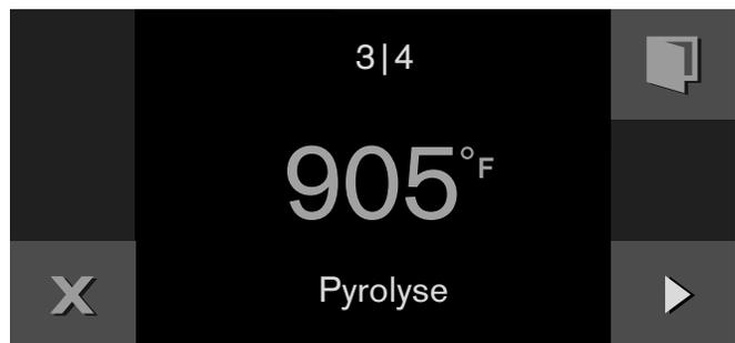
Un signal sonore est émis après 3 heures. Un message s'affiche. Une fois que l'appareil a refroidi, essuyer les cendres avec un chiffon humide.
