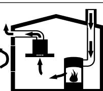
Источники пламени с подводом воздуха из помещения (например, работающие на газе, жидким топливе, дровах или угле нагреватели, проточные водонагреватели, бойлеры) получают воздух для сжигания топлива из помещения, где
