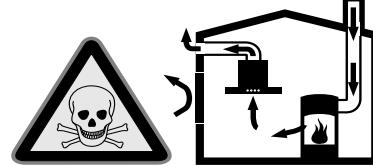
Zależne od powietrza w pomieszczeniu urządzenia spalające (np. grzejniki na gaz, olej, drewno lub węgiel, przepływowe podgrzewacze wody i inne podgrzewacze wody) pobierają powietrze do spalania z pomieszczenia, w którym się znajdują, a spalinę odprowadzają przez układ wylotowy (np. komin) na zewnątrz.
