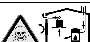
Εστίες, εξαρτημένες από τον αέρα του περιβάλλοντος (π.χ. συσκευές θέρμανσης που λειτουργούν με αέριο, πετρέλαιο, ξύλο ή άνθρακα, ταχυθερμοσίφωνες, θερμαντήρες νερού) λαμβάνουν τον αέρα για καύση από το χώρο τοποθέτησης και οδηγούν τα καυσαέρια μέσα από μια εγκατάσταση απαγωγής των καυσαερίων (π.χ. καμινάδα) στον έξω χώρο.
