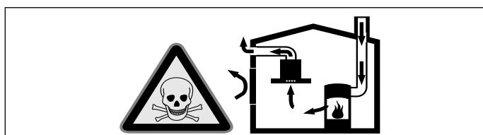
Hava dolaşımı ateşlikler (örneğin gaz, yağı, odun veya kömürle çalışan sobalar, şofbenler, su ısıtıcıları) yanma havasını kurulum yerinden alırlar ve atık gazı bir atık gaz sistemi (örneğin baca) kanalıyla dışarıya aktarırlar.
