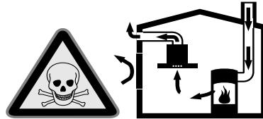
Источники пламени с подводом воздуха из помещения (например, работающие на газе, жидком топливе, дровах или угле нагреватели, проточные водонагреватели, бойлеры) получают воздух для сжигания топлива из помещения, где они установлены, а отработавшие газы отходят через вытяжную систему (например, вытяжную трубу) из помещения на улицу.
