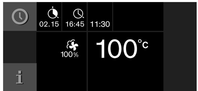
电器切换至待机模式。加热模式、温度、烹饪时间和烹饪结束时间显示在显示屏中。电器按照计算出的时间启动，然后在烹饪时间到后自动关断。
