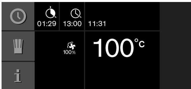
Et minut, inden tilberedningstiden er udløbet, vises den udløbende tilberedningstid forstørret.
