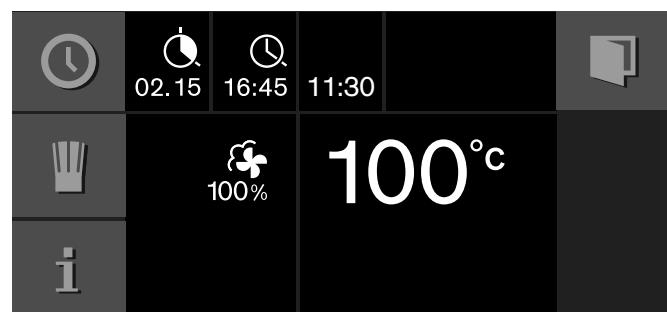
Apparaten ställer sig i vänteläge. I displayen visas funktion, temperatur, tillagningstid och tillagningtidens slut. Apparaten startar vid den uträknade tidpunkten och stänger av automatiskt när tillagningstiden är slut.
