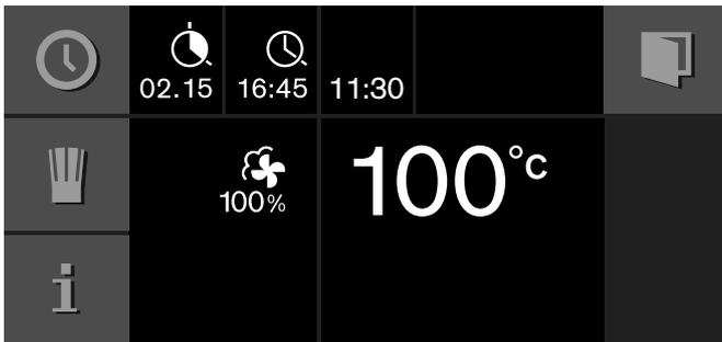
电器切换至待机模式。加热模式、温度、烹饪时间和烹饪结束时间显示在显示屏中。电器按照计算出的时间启动，然后在烹饪时间到时无声关断。
