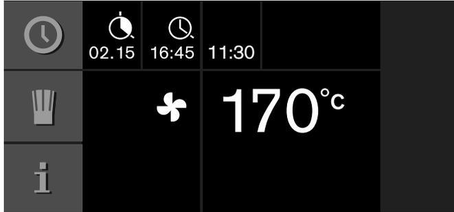
Cihaz bekleme konumuna geçer. Ekranda çalışma modu, sıcaklık, pişirme süresi ve pişirme süresi sonu gösterilir. Cihaz hesaplanan vakitte çalışmaya başlar ve pişirme süresi sona erdiğinde otomatik olarak kapanır.
