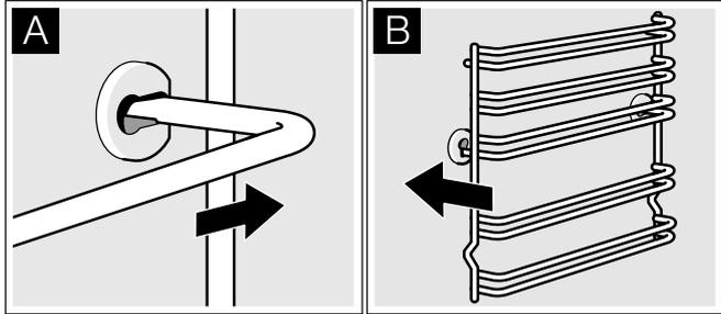
Taşıyıcı ızgaralar sağ ve sol tarafa takılabilirler. Şekil B'de görüldüğü gibi taşıyıcı ızgaranın çıkıntılı tarafının aşağıya bakmasına dikkat edin.
