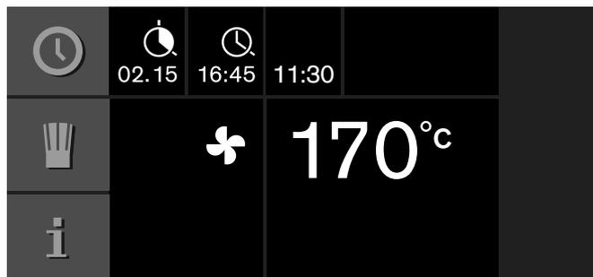
Apparatet er i venteposisjon. I displayet vises driftstypen, temperaturen, tilberedningstiden og tilberedningstid slutt. Det starter til beregnet tidspunkt og kobler automatisk ut når tilberedningstiden er utløpt.
