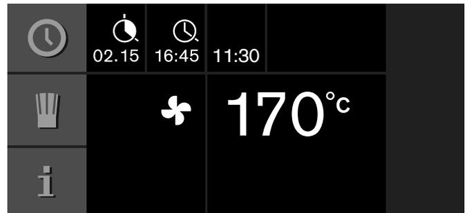
Cihaz bekleme konumuna geçer. Ekranda çalışma modu, sıcaklık, pişirme süresi ve pişirme süresi sonu gösterilir. Cihaz hesaplanan vakitte çalışmaya başlar ve pişirme süresi sona erdiğinde otomatik olarak kapanır.
