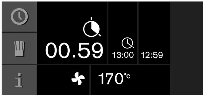
Piştirme süresi sona erdikten sonra cihaz kapanır. ⌚ sembolü titrer ve akustik sinyal duyulur. ✓ sembolüne dokunduğunuzda, cihazın kapısını açtığınızda veya fonksiyon seçme düğmesini 0 konumuna getirdiğinizde akustik sinyal kesilir.
