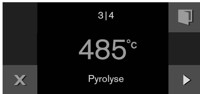
Efter 3 timer høres et signal. En besked vises i displayet. Når apparatet er afkølet, tørres asken, som bliver tilovers, ud af ovnrummet med en fugtig klud.
