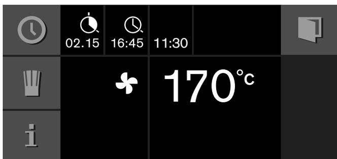
Apparatet går i venteposition. I displayet vises ovnfunktion, temperatur, tilberedningstid og sluttidspunkt for tilberedningen. Apparatet starter på det beregnede tidspunkt og slukker automatisk, når tilberedningstiden er udløbet.
