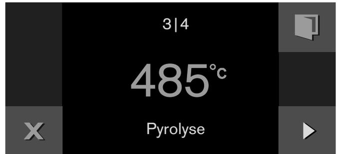
Un signal sonore est émis après 3 heures. Un message s'affiche. Une fois que l'appareil a refroidi, essuyer les cendres avec un chiffon humide.
