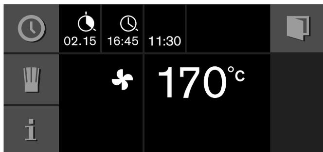
L'appareil est en position d'attente. Sur l'afficheur, le mode, la température, le temps de cuisson et la fin de cuisson sont visibles. L'appareil démarre à l'heure calculée et s'arrête automatiquement lorsque le temps de cuisson s'est écoulé.
