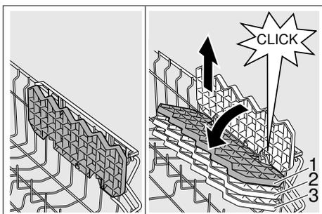
\* Según modelo, el soporte se puede ajustar en tres posiciones diferentes. Poner a tal efecto el soporte primero en posición vertical y tirar del mismo hacia arriba, colocarlo en posición ligeramente oblicua y desplazarlo a la posición que se desea ajustar (1, 2 ó 3) . Enclavarlo de modo audible en la posición seleccionada.
