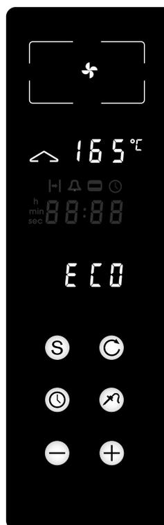
Con el modo de funcionamiento de eficiencia energética Aire caliente eco se pueden preparar infinidad de platos en un único nivel. El ventilador reparte de manera uniforme por todo el interior del horno el calor optimizado energéticamente del calentador circular situado en la placa posterior.
