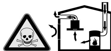
Otevřené spotřebiče na paliva (např. topné spotřebiče, průtokové ohřívače, bojlerы na plyn, olej, dřevo nebo uhlí) odebírají vzduch pro spalování z místnosti, kde jsou nainstalované, a odvádějí spaliny zařízením pro odvod spalin (např. komínem) ven.
