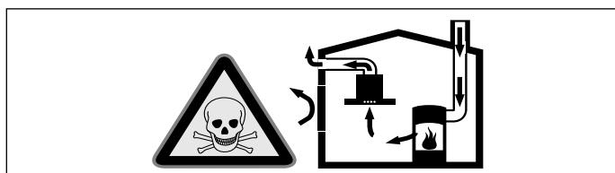
I focolari che dipendono dalla temperatura ambiente (per es. a gas, olio, legna o carbone, scaldabagno, caldaie elettriche) riscaldano l'aria per la combustione presente nella stanza ed eliminano i gas di scarico all'esterno attraverso un impianto (per es. camino).
