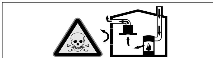
Les foyers à air ambiant (par exemple les chauffages à gaz, à bois, à fioul ou à charbon, les chauffe-eau instantanés, les ballons d'eau chaude) prélèvent l'air de combustion dans la pièce où ils sont installés et rejettent les gaz de fumée à l'air libre par un système spécifique (cheminée par exemple).
