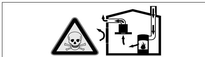
Kooktoestellen die de lucht in de ruimte verbruiken (bijv. apparaten die op gas, olie, hout of kolen worden gestookt, geisers, warmwatertoestellen) trekken de verbrandingslucht uit de ruimte van opstelling en voeren de gassen via een afvoer (bijv. schoorsteen) af naar buiten.
