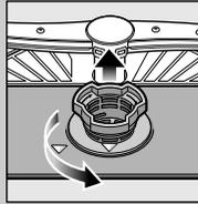
Rodar o filtro cilíndrico e retirar o sistema de filtros ...
