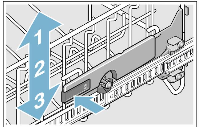
4. Oberen Geschirrkorb **anheben**; oberen Geschirrkorb am oberen Rand fassen und anheben.
