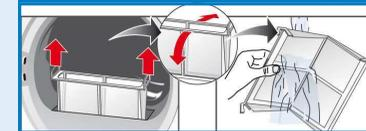
4. Fermez, remplacez les filtres à peluches l'un dans l'autre, puis remettez-les en place.
