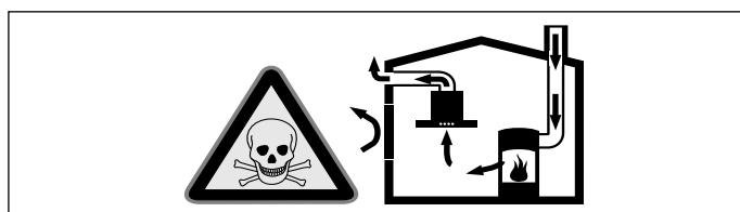
Eldständer som är beroende av rumsluft (t.ex. värmeverk som drivs med gas, olja, ved eller kol, genomströmningsapparater, varmvattenberedare) tar sin förbränningsslutur ur det utrymme där enheten är installerad och leder ut avgaserna i det fria via en avgasanläggning (t.ex. skorsten).
