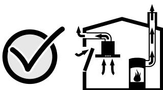
Rådgör i varje enskilt fall med lokalt ansvarig sotare, som kan bedöma husets ventilationssystem i sin helhet och föreslå lämpliga åtgärder för ventilationen. Om köksfläkten körs enbart med cirkulationsdrift, kan den användas utan begränsningar.
