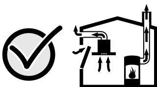
Du bør i alle fall rådføre deg med skorsteinsfeieren, som kan bedømme husets tilførselsluft og avtrekksluft og foreslår passende tiltak for ventilasjonen.
