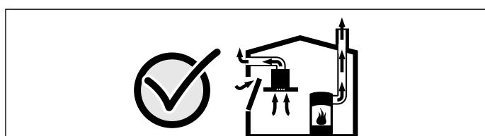
Du bør i alle fall rådføre deg med skorsteinsfeieren, som kan bedømme husets tilførselsluft og avtrekksluft og foreslår passende tiltak for ventilasjonen.
