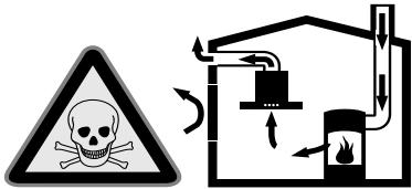
Huoneilmaa tarvitsevat tulisijat (esim. kaasu-, öljy-, puu- tai hiilikäyttöiset lämmityslaitteet, läpivirtauskuumennin, vedenkuumennin) ottavat polttoilman huonetilasta ja johtavat polttoilman poistoilmalaitteen (esim. savutorven) kautta ulos. Tuuletin imkeelee keittiöstä ja sen viereistä huoneista ilmaa - tämä on korvattava riittäväällä tuloilmalla - muutoin syntyy alipaine. Myrkkyiset kaasut imetyisivät takaisin huoneisiin savutorvesta tai poistoilmakanavasta.
