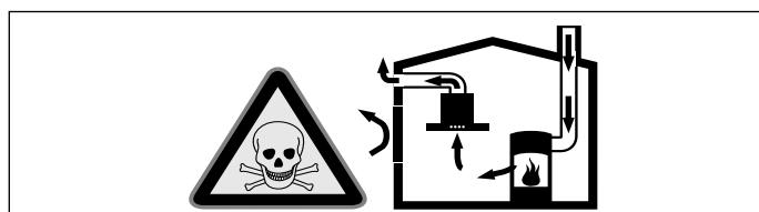
Eldstäder som är beroende av rumsluft (t.ex. värmeapparater som drivs med gas, olja, ved eller kol, genomströmningsapparater, varmvattenberedare) tar sin förbränningluft ur det utrymme där enheten är installerad och leder ut avgaserna i det fria via en avgasanläggning (t.ex. skorsten).
