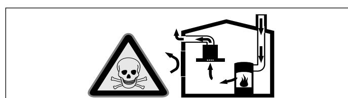
Huoneilmaa tarvitsevat tulisijat (esim. kaasu-, öljy-, puu- tai hiilikäyttöiset lämmityslaitteet, läpivirtauskuumennin, vedenkuumennin) ottavat polttoilman huonetilasta ja johtavat poistoilman poistoilmalaitteen (esim. savutorven) kautta ulos.
