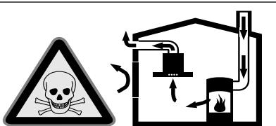
Εστίες, εξαρτημένες από τον αέρα του περιβάλλοντος (π.χ. συσκευές θέρμανσης που λειτουργούν με αέριο, πετρέλαιο, ξύλο ή όνθρακα, ταχυθερμοσίφωνες, θερμαντήρες νερού) λαμβάνουν τον αέρα για καύση από το χώρο τοποθέτησης και οδηγούν τα καυσαέρια μέσα από μια εγκατάσταση απαγωγής των καυσαερίων (π.χ. καμινάδα) στον έξω χώρο.
