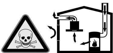
Источники пламени с подводом воздуха из помещения (например, работающие на газе, жидким топливе, дровах или угле нагреватели, проточные водонагреватели, бойлеры) получают воздух для сжигания топлива из помещения, где они установлены, а отработавшие газы отходят через вытяжную систему (например, вытяжную трубу) из помещения на улицу.
