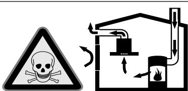
Hava dolaşımı ateşlikler (örneğin gaz, yağ, odun veya kömürle çalışan sobalar, şofbenler, su ısıtıcıları) yanma havasını kurulum yerinden alırlar ve atık gazı bir atık gaz sistemi (örneğin baca) kanalıyla dışarıya aktarırlar.
