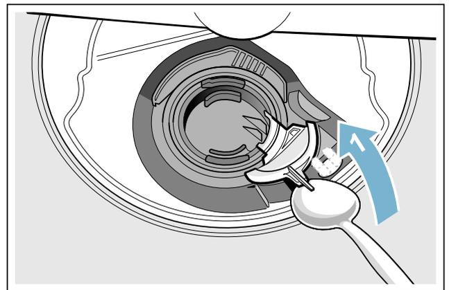
6. Vérifiez si la roue à aubes présente des corps étrangers et retirez-les le cas échéant.
