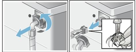
3. Raccorder le flexible et vérifier son étanchéité.
