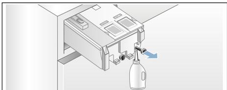
d) Réintroduire le bouchon obturateur jusqu'en butée.
