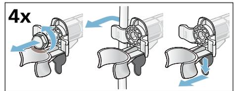
3. Mettre les couvercles en place. Verrouiller fermement les couvercles en appuyant sur le crochet de blocage.
