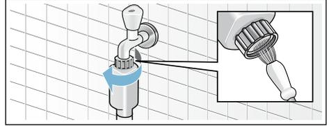
2. Nettoyage du filtre à l'arrière de l'appareil sur les modèles Standard et Aqua-Secure :
