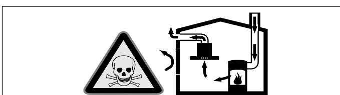
Eldstäder som är beroende av rumsluft (t.ex. värmearrater som drivs med gas, olja, ved eller kol, genomströmningsapparater, varmvattenberedare) tar sin förbränningsslut ur det utrymme där enheten är installerad och leder ut avgaserna i det fria via en avgasanläggning (t.ex. skorsten).
