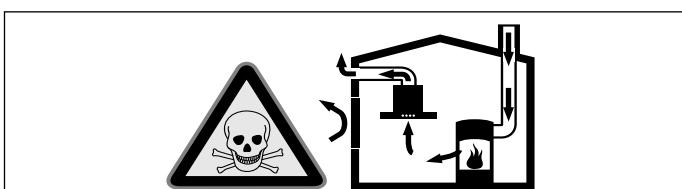
Huoneilmaa tarvitsevat tulisijat (esim. kaasu-, öljy-, puu- tai hiilikäyttöiset lämmityslaitteet, läpivirtauskuumennin, vedenkuumennin) ottavat polttoilman huonetilasta ja johtavat poistoilman poistoimalaitteen (esim. savutorven) kautta ulos.
