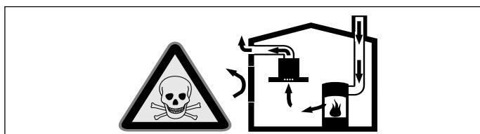
Eldständer som är beroende av rumsluft (t.ex. värmearrapparater som drivs med gas, olja, ved eller kol, genomströmningsapparater, varmvattenberedare) tar sin förbränningsslut ur det utrymme där enheten är installerad och leder ut avgaserna i det fria via en avgasanläggning (t.ex. skorsten).
