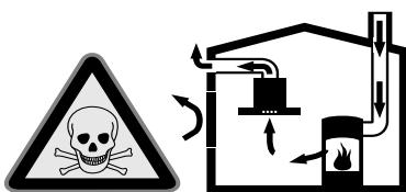
Huoneilmaa tarvitsevat tulisijat (esim. kaasu-, öljy-, puu- tai hiilikäyttöiset lämmityslaitteet, läpivirtauskuumennin, vedenkuumennin) ottavat polttoilman huonetilasta ja johtavat poistoilman poistoilmalaitteen (esim. savutorven) kautta ulos.
