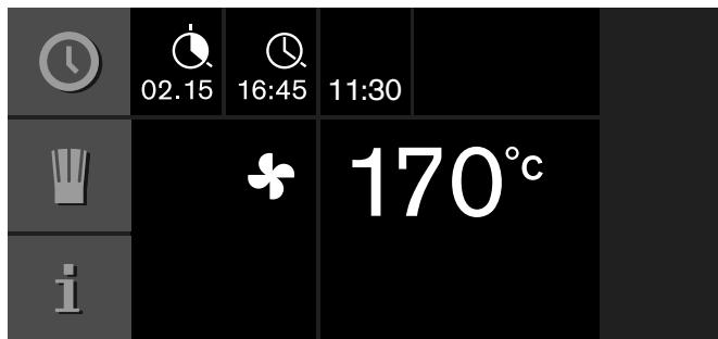
電器切換至待機狀態。螢幕上顯示加熱方式、溫度、烹調時間、及烹調結束時間。電器在預先計劃的時間內啟動。當烹調時間消逝後，它自動關閉。
