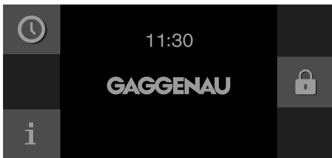
兒童安全鎖已經啟動。顯示 待機畫面。
