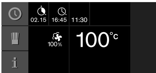
電器切換至待機狀態。螢幕上顯示加熱方式、溫度、烹調時間、及烹調時間終止。電器在預先計劃的時間內啟動。當烹調時間消逝後，它自動關閉。
