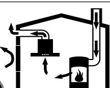
依賴室內空氣的製熱裝置（例如以氣體、汽油、木材或以煤炭為燃料的暖爐、循環加熱器或熱水器）係從其安裝處取得空氣加以燃燒，再經由排氣系統（例如煙囪）將廢氣排放至室外。
