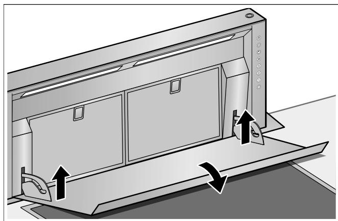
可將過濾蓋抬高超過固定座螺栓的高度。
